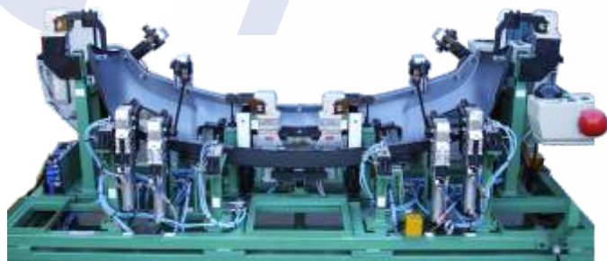
DISPOSITIVO ELECTRONEUMÁTICO DE ENSAMBLADO GENERAL PIEZA PARAGOLPES DELANTERO CLIENTE: GESTAMP AUTOMOCION - PROYECTO: FORD RANGER 2005
