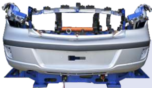
CALIBRE DE CONTROL PARAGOLPES TRASERO CLIENTE: GENERAL MOTORS - PROYECTO: VIVA
