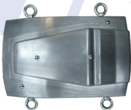
MOLDE DE CONFORMADO DE AEROPARTE DE CHAPA CLIENTE: FADEA S.A.
