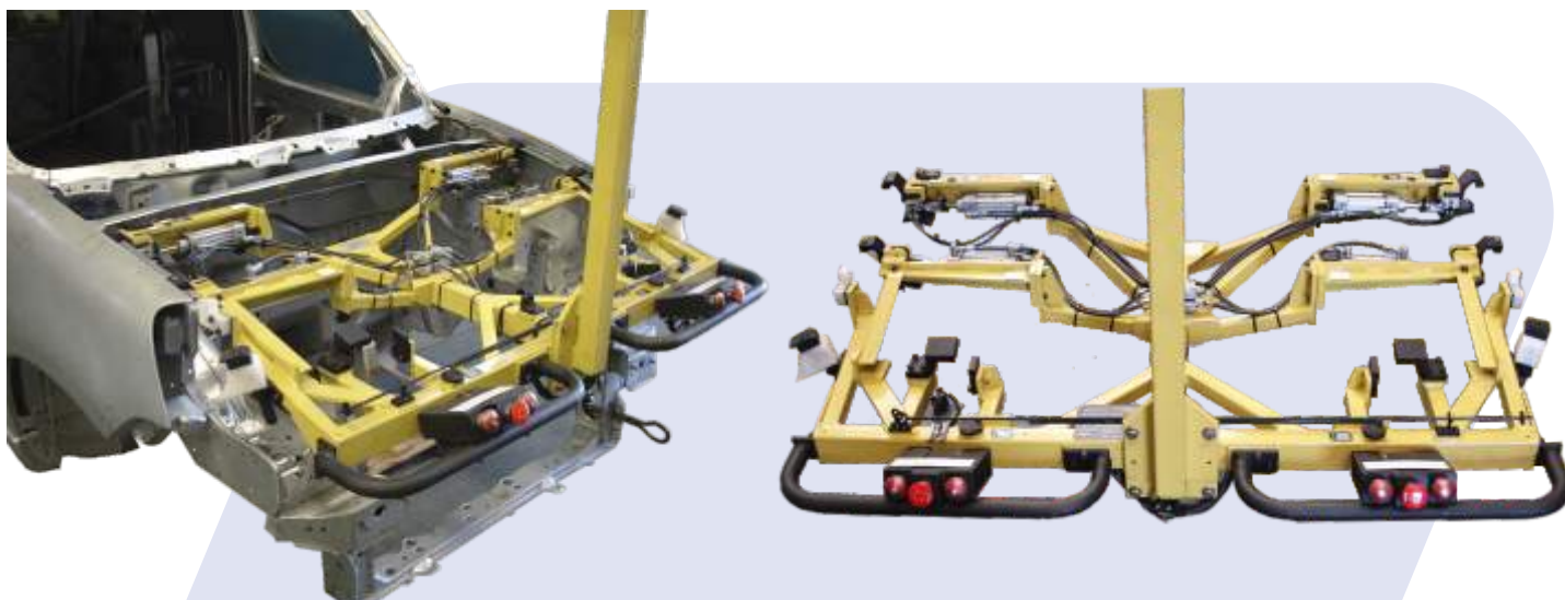
DISPOSITIVO NEUMÁTICO DE COLOCACIÓN DE CAPOT CLIENTE: PSA PEUGEOT CITROEN - PROYECTO: M59
