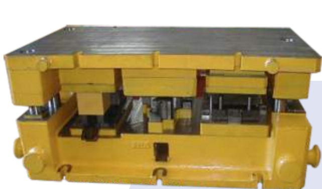
MATRIZ PROGRESIVA REFUERZO DE PISO CLIENTE: MA AUTOMOTIVE - PROYECTO: T3
