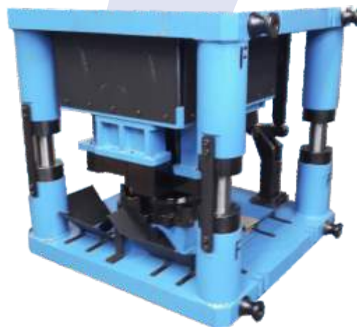
MATRIZ DE REBABADO DE CARCAZA DE EMBRAGUE CLIENTE: VOLKSWAGEN - PROYECTO: MQ200/MQ250
