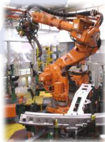
CELDA DE SOLDADURA ROBOTIZADA - PIEZAS RENFORT LONGERON + DOUBLURE ARC PAVILLON CLIENTE: GESTAMP AUTOMOCION - PROYECTO: B5
