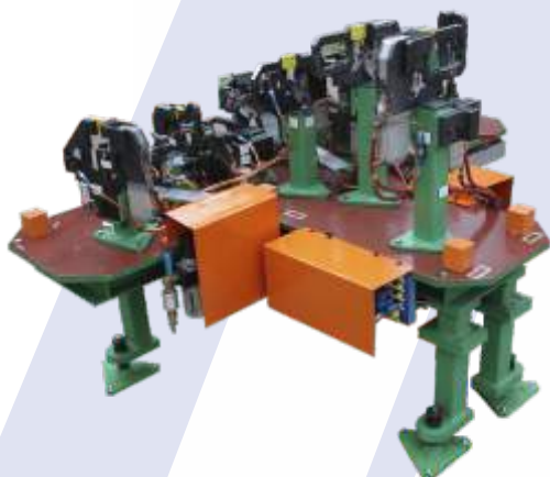
DISPOSITIVO ELECTRONEUMÁTICO DE SOLDADURA PIEZA ARC PAVILLON CLIENTE: GESTAMP AUTOMOCION - PROYECTO: B5
