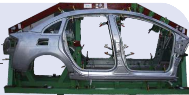
CALIBRE DE CONTROL LATERALES MI / MD CLIENTE: PSA PEUGEOT CITROEN - PROYECTO: B5
