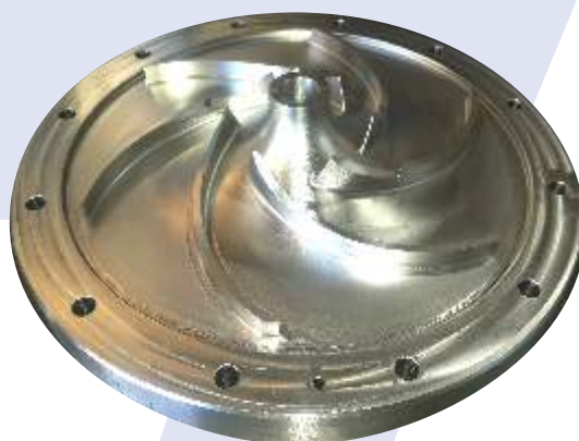
IMPULSOR BOMBA DE COMBUSTIBLE CLIENTE: CONAE / VENG S.A. - PROYECTO: TRONADOR II
