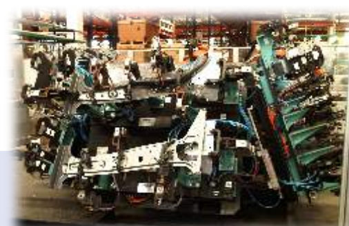
CELDA DE SOLDADURA ROBOTIZADA POLIVALENTE CON DISPOSITIVOS GIRATORIOS INTERCAMBIABLES - 16 CONJUNTOS A SOLDAR CLIENTE: GESTAMP AUTOMOCION - PROYECTO: B7
